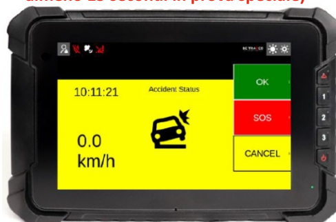
Schermata di probabile incidente (appare dopo uno stop di almeno 15 secondi in prova speciale)
